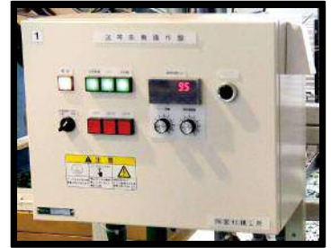
蒸し時間がわかり易い デジタル表示を採用。 ネットスピード（蒸し時間） の設定は、ボリュームダイヤルで 簡単に変更できます。
